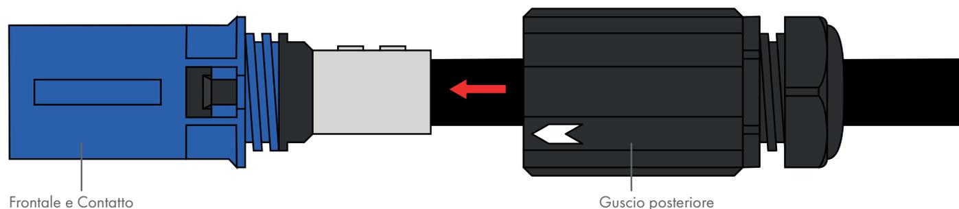
1. Girare in senso orario, assicurarsi che la freccia sul guscio posteriore sia in linea con il perno di posizionamento frontale.
