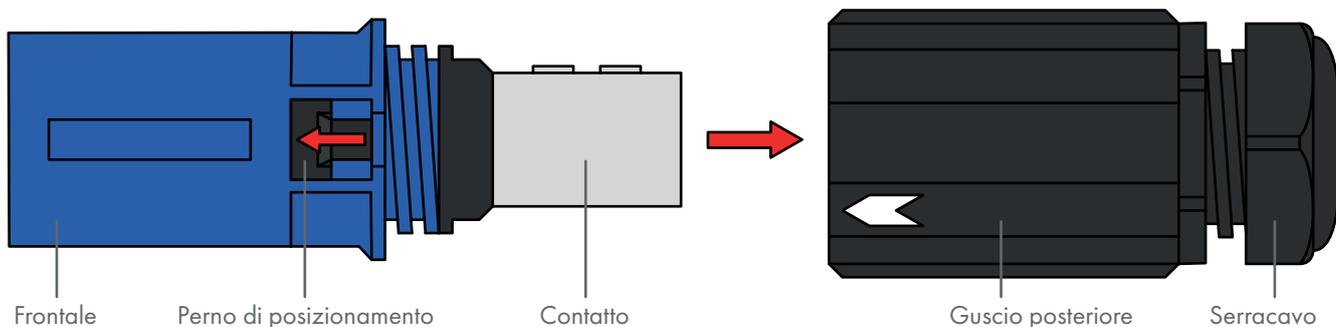
2. Per il riassetaggio far scorrere giù per il cavo il guscio posteriore ed il serracavo, inserire il contatto nel guscio frontale. N.B. nel contatto maschio (come mostrato nell'immagine sottostante) la scanalatura deve essere allineata con la chiave di allineamento del guscio frontale. Non richiesto nei contatti Line Drain.
